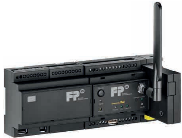
Abbildung 6: FP Secure Gateway (Mitte) in der Bauform „Hutschiene“
